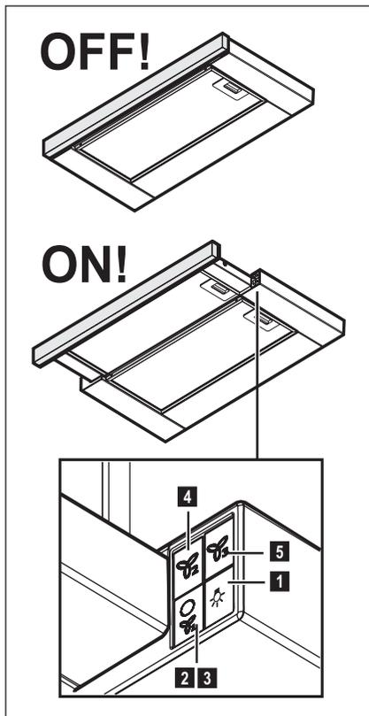
1. Вклучување/Исклучување на светлото
