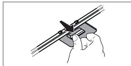
**4.2 Φίλτρο ενεργού άνθρακα που πλένεται -** Το φίλτρο άνθρακα μπορεί να πλυθεί ανά δύο μήνες σε ζεστό νερό και ουδέτερο απορρυπαντικό ή σε πλυντήριο πιάτων σε 65°C (σε περίπτωση πλυσίματος σε πλυντήριο πιάτων, χρησιμοποιήστε έναν πλήρη κύκλο πλυσίματος χωρίς την παράλληλη παρουσία πιάτων).
