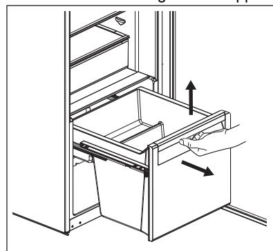
2. Skyv skinnene inne i skapet for å unngå skade på produktet når du lukker døren.
