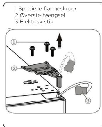
4. Tag den øverste låge af det midterste hængsel ved forsigtigt at løfte lågen lige op. Placer derefter den øverste låge på en glat overflade med dens øverste dækSEL opad.
