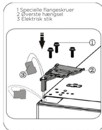
16. Tilslut elektrisk stik 1 som vist på billedet, og fastgør derefter del 2 med skrue 3 - se trin 2.
