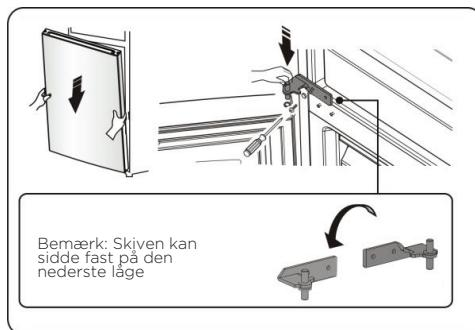
15. Flyt den øverste låge til en passende position, og fastgør derefter del 2 med skruer 1. Før du fastgør del 2, skal du føre stik 3 gennem hængsel 2 - se trin 3. (Hold øverste låge i hånden, når du installerer).
