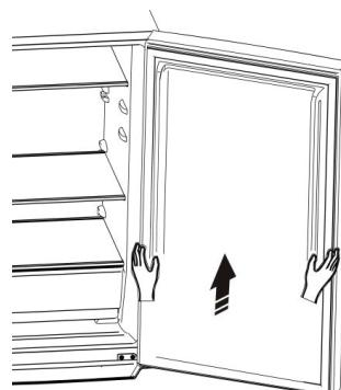
5. Tag skruehulsdækslet (til højre) fra plastikposen og installer det på øverste højre side af koleskabeskroppen. Fjern derefter skruehulsdækslet (til venstre) fra øverste venstre side af apparatet og læg det i plastikposen.
