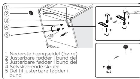
12. Fjern del 3 fra den nederste hængselstift, løsn og fjern den nederste hængselstift, sæt den i stedet i det modsatte hul og spænd derefter, til den sidder på plads. Installer derefter del 3 på den nederste hængselstift.
