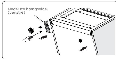
14. Sæt den nederste låge på den nederste hængselstift, og sæt den på plads. Drej det midterste hængsel 180°, skift skiven på aksen til undersiden, juster det midterste hængsel til en passende position, og installer det, så den nederste låge sidder rigtigt.
