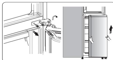
9. Placer den nederste låge på en glat overflade med panelet opad. Løsn skrue 3, og tag del 2 og del 1 ud. Installer den medfølgende udskiftningsstopper i lågagens venstre side 4 (i plastikposen) og del 2 (stopklods) i venstre side med skrue 3. Opbevar del 1 sammen med apparatet til fremtidig reference.
