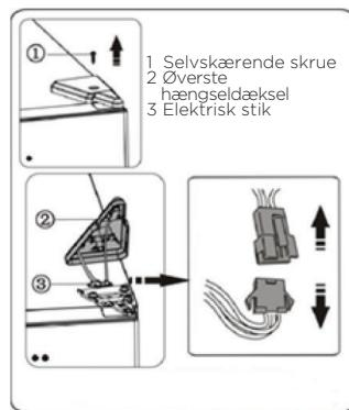
3. Fjern skruer 1 og hængsel 2. Før derefter stik 3 gennem hullet på hængsel 2.
