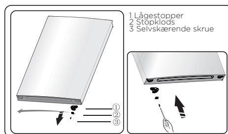
8. Løsn skruerne, der er brugt til at fastgøre det midterste hængsel, og fjern
