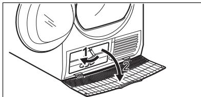
4. Om nødvendig, fjern lo fra kondensatoren og den tilhørende beholderen. Du kan bruke en støvsuger med børste.
